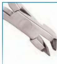
P1914-00 Micro tronchesino distale Manici lunghi, con trattenuta del filo. Massima capacità di taglio: -filo rettangolare .022" x .028" (0,56 x 0,71 mm) -filo tondo .020" (0,51 mm) -filo twist .016" (0,41 mm) cod 00029326 € 198,30
